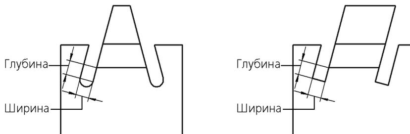
Определение размеров освобождения сгиба при отличном от нуля угле на сгибе
