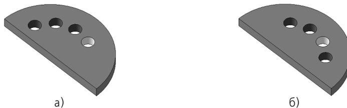
Изменение положения экземпляров в массиве относительно базового экземпляра
