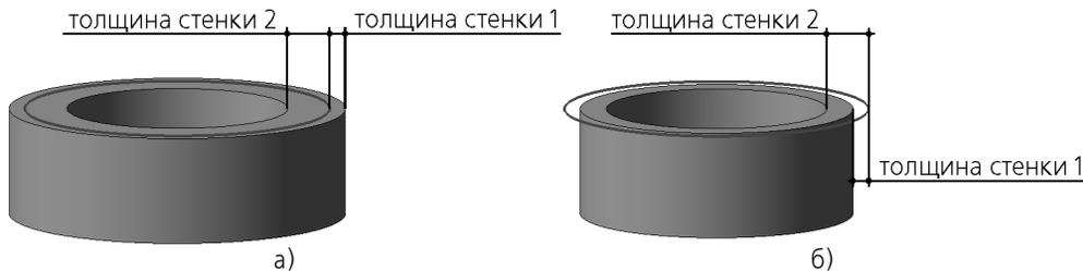
Пример построения тонкостенного элемента при выдавливании (материал добавляется в двух направлениях; сечение показано утолщенной линией)
