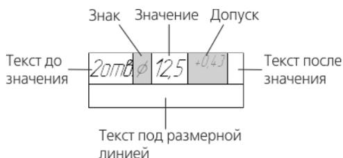
Таблица ввода размерной надписи при простановке линейного размера
