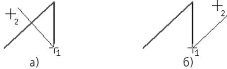
Построение последующего отрезка автолинии
