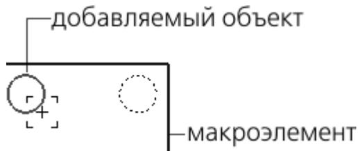
Указание объектов для добавления в макроэлемент (в режиме его редактирования)
