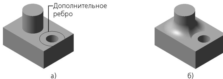
Использование ребра, полученного разбиением грани
