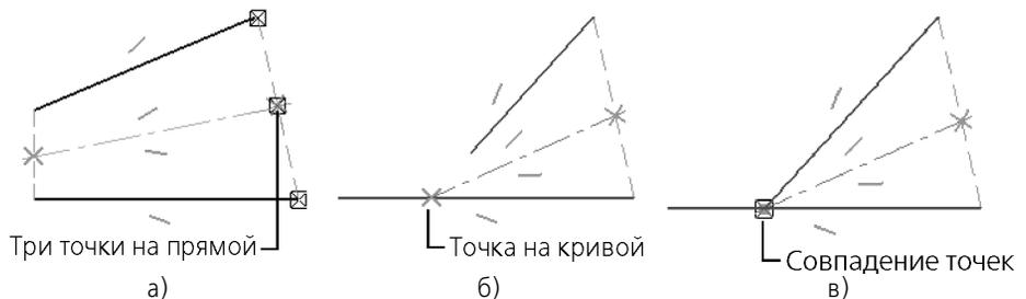
Ограничения, наложенные на автоосевую при различном расположении отрезков
