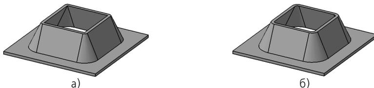
Открытая штамповка с уклоном боковых стенок и скругленными боковыми ребрами:
