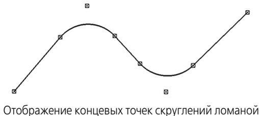
Отображение концевых точек скруглений ломаной
