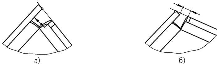
Максимальный зазор при замыкании с перекрытием
