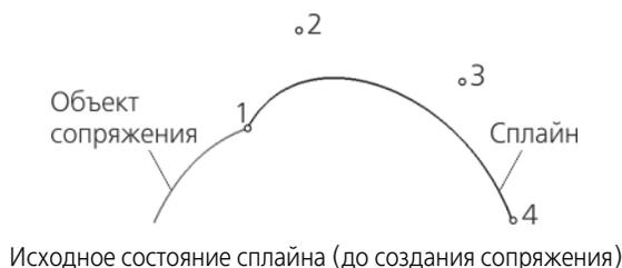
Перемещение точек сплайна при создании сопряжений с разными условиями
