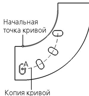
Пример построения массива вдоль кривой при автоопределении базовой точки базового экземпляра
