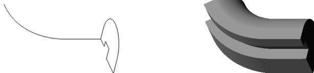
Сечение, направляющая и элемент по траектории
