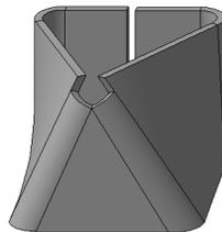
Пример освобождения угла при пересечении сгибов линейчатой обечайки
